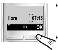
▶ Indique la hora y los minutos con 4 dígitos mediante el teclado, p. ej. [0.5] para las 07:15. Utilice la tecla de control para cambiar entre los campos.
