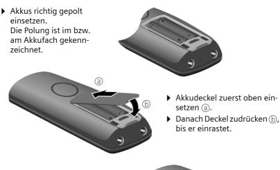
Falls Sie den Akkudeckel wieder öffnen müssen, um z. B. die Akkus zu wechseln, greifen Sie in die Mulde am Gehäuse und ziehen den Akkudeckel nach oben.
