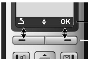
Aktuelle Funktionen der Display-Tasten werden in der untersten Displayzeile angezeigt.
