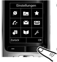
Navigieren Sie mit der Steuer-Taste nach rechts, links, oben und unten
