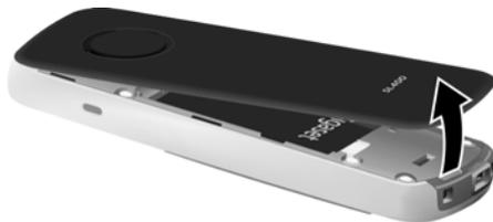
Pour **changer la batterie**, insérer un ongle dans l'encoche du boîtier et tirer la batterie vers le haut.
