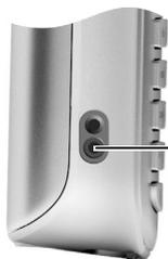
Une fois le couvercle en plastique retiré, vous pouvez raccorder un kit piéton sur le côté gauche de votre téléphone à l'aide d'une prise de 2,5 mm.
