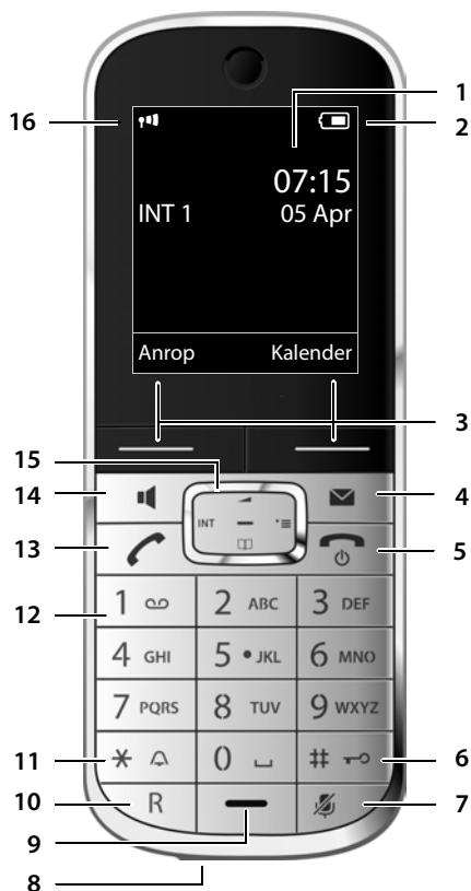
1 **Display** i hviletilstand2 **Batteriets ladetilstand** (→ s. 11)3 **Displaytaster** (→ s. 4)4 **Beskjedtast** (→ s. 21)Tilgang til anrops- og beskjedlister;
