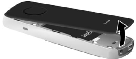
Para **cambiar la batería** introduzca la uña en la muesca de la carcasa y levante la batería.
