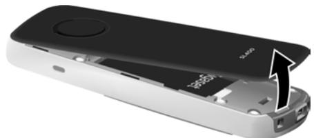
Para **substituir a bateria** segure na ranhura da caixa com a unha e retire a bateria para cima.
