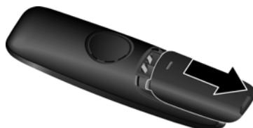
Pour ouvrir de nouveau le couvercle des batteries pour changer les batteries par exemple, appuyer sur la partie striée, au niveau de la partie supérieure du couvercle et la faire glisser vers le bas.
