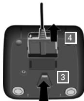
Si vous devez à nouveau retirer le connecteur du chargeur, appuyez sur le bouton de déverrouillage **3** et retirez le connecteur **4**.
