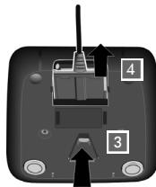
Si vous devez à nouveau retirer le connecteur du chargeur, appuyez sur le bouton de déverrouillage **3** et retirez le connecteur **4**.
