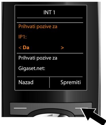
Ako na mobilnoj slušalici ne trebaju biti signalizirani pozivi na VoIP-vezi IP1:
