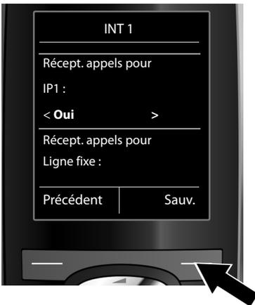
Pour qu'aucun appel ne soit signalé sur la connexion VoIP IP1 du combiné :
