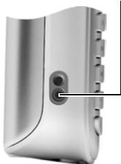
Сняв пластиковую крышку, вы можете с левой стороны телефона 2,5-мм штекером подключить проводную гарнитуру.
