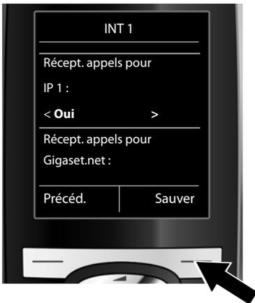
Pour qu'aucun appel ne soit signalé sur la connexion VoIP IP 1 du combiné :
