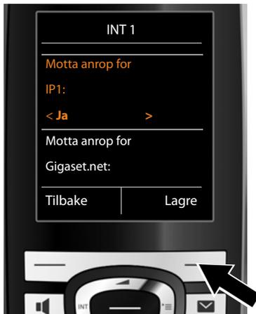
Hvis det ikke skal signaliseres anrop på VoIP-forbindelsen IP1 på håndsettet:
