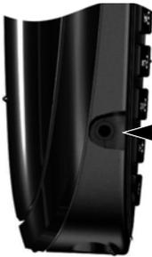
Du kan koble til et hodesett med 2,5 mm jackpluggen. Du finner anbefalinger om kompatible headset på den respektive produktsiden på [www.gigaset.com](http://www.gigaset.com).
