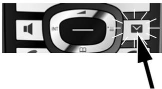
Når håndsettets batteri er tilstrekkelig ladet, blinker håndsettets beskjedtast
