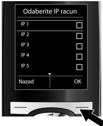
Na zaslонu je prikazana lista sa svim mogućim IP-vezama (IP 1 do IP 6). Već konfiguirane VoIP-veze označene su sa .
