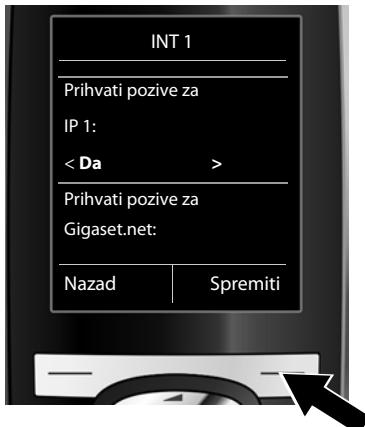
Ukoliko na mobilnoj slušalici ne trebaju biti signalizirani pozivi na VoIP-vezu IP 1:
