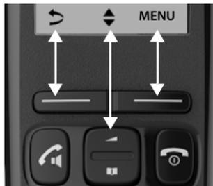
**Display-Funktionen, die über die Steuer-Taste bedient werden**
