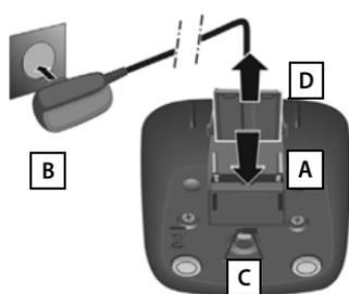
▶ Flachstecker des Steckernetztes anschließen **A**.
