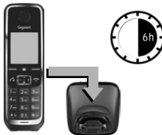
À la livraison, les batteries sont partiellement chargées. Veuillez les charger complètement avant de les utiliser. La batterie est complètement chargée lorsque l'icône représentant un éclair ⚡ s'allume sur l'écran.
