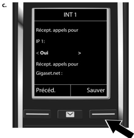
Pour qu'aucun appel ne soit signalé sur la connexion VoIP **IP 1** du combiné :
