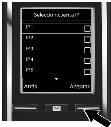
En la pantalla se visualiza una lista con todas las conexiones IP disponibles (de IP 1 hasta IP 6). Las conexiones VoIP ya configuradas aparecen marcadas con .
