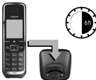
Le batterie vengono consegnate parzialmente cariche. Caricarle completamente prima dell'uso. Le batterie sono in stato di carica quando sul display appare il simbolo del flash ⚡.
