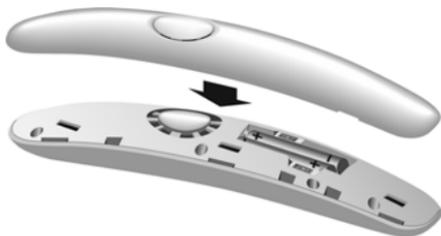
Per aprire il coperchio delle batterie: ► Fare pressione sulla scanalatura e sollevare il coperchio.
