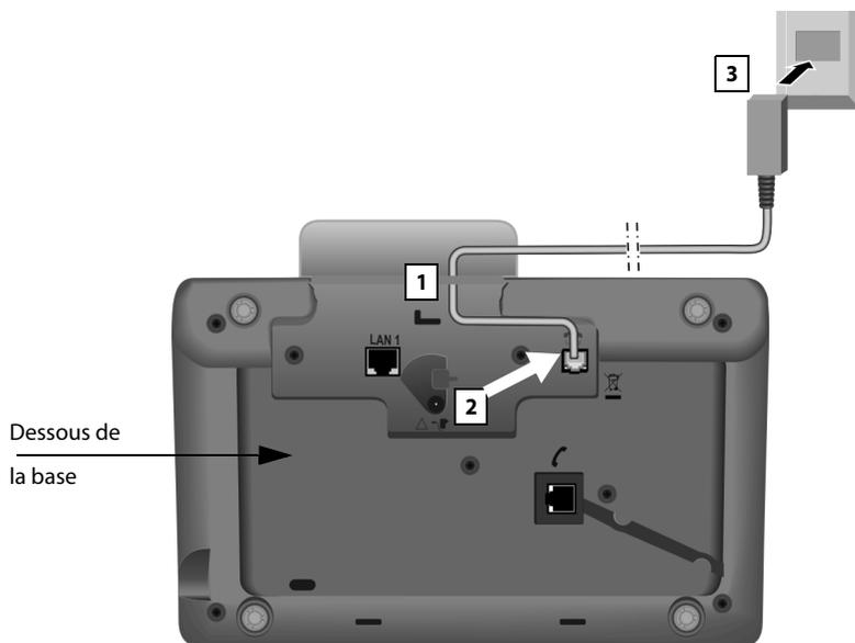
1. Introduire une extrémité du cordon téléphonique (câble de connexion TTT89 avec fiche RJ11) par l'arrière, dans le conduit du boîtier.
