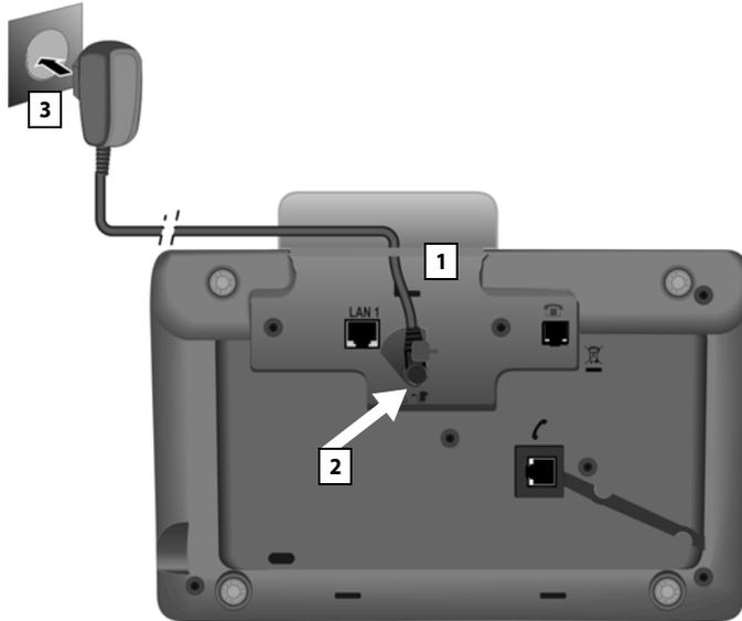
1. Insérer le petit connecteur du câble réseau par l'arrière dans l'orifice du boîtier.
