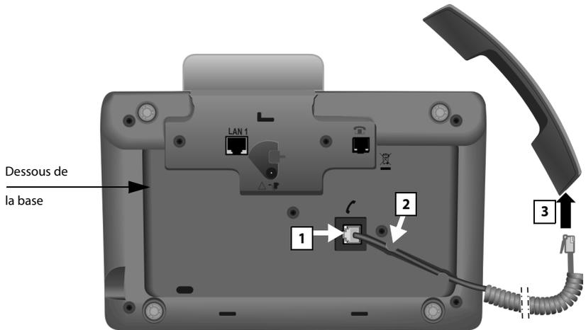
1. Insérer le connecteur qui se trouve à l'extrémité longue du cordon non spiralée dans la prise signalée par l'icône
