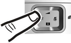
Zur Korrektur: Drücken Sie auf den linken bzw. rechten Rand der Steuer-Taste, um die Eingabeposition zu wechseln.
