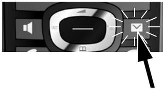
Si la batería del terminal inalámbrico está lo suficientemente cargada, parpadea la tecla de mensajes
