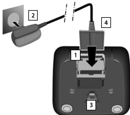
Для отсоединения штекерного разъема от зарядной подставки выполните следующие действия.
