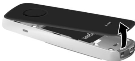
Per **estrarre la batteria** inserire un'unghia nella fessura indicata in figura e sollevare il pacchetto batterie verso l'alto.
