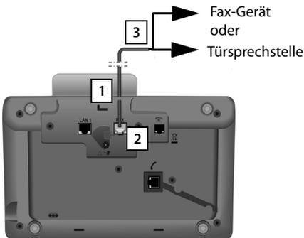
1. Führen Sie ein Ende des Anschlusskabels (6-polig mit 2 Miniwestern-Steckern 6/6) von hinten durch die Aussparung im Gehäuse Ihres Telefons.
