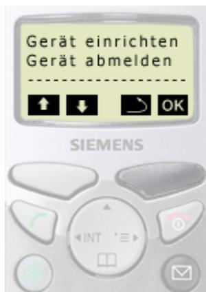
5. "Gerät einrichten" bestätigen mit Displaytaste **OK**.
