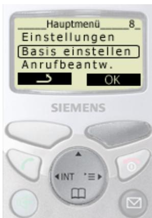
2. "Basis einstellen" wählen, Steuertaste
