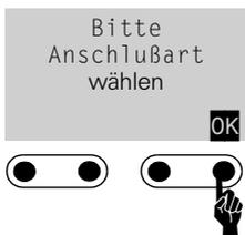
Wählen Sie „**Hauptanschluß**“, wenn Sie das Basistelefon direkt an das ISDN-Netz anschließen.
