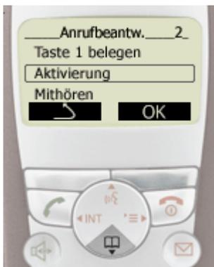
3. "Aktivierung" wählen mit Steuertaste
