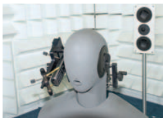
Kopfarbeiter: Die Messungen im Telefonbetrieb erfolgen an einem künstlichen Kopf.
