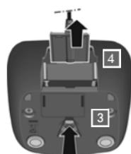
Dacă trebuie să deconectați fișa de la suportul încărcător, apăsați butonul de eliberare 3 și deconectați fișa 4.
