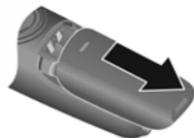
Снятие крышки аккумуляторного отсека:
