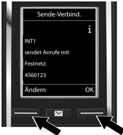
Es wird die aktuell für das Mobilteil eingestellte Sende-Verbindung angezeigt: **Festnetz**.
