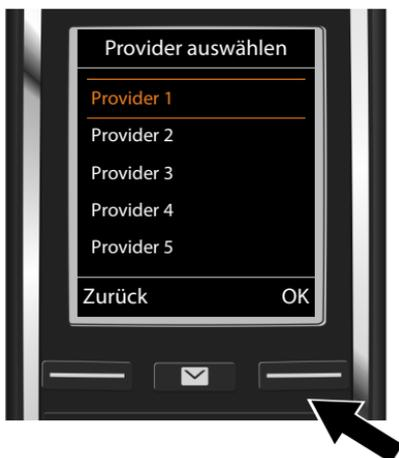
Es wird eine Liste der VoIP-Provider angezeigt, für die auf dem Konfigurationsserver ein Profil mit den allgemeinen Zugangsdaten zur Verfügung steht.
