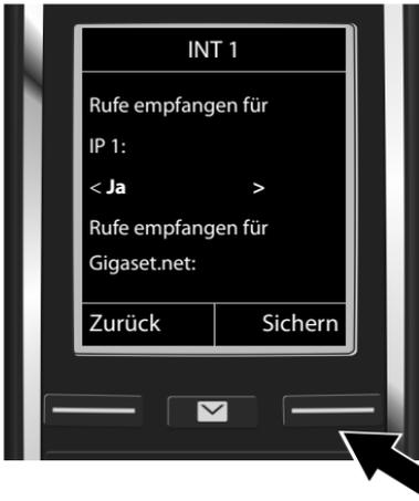
Sollen an dem Mobilteil keine Anrufe an die VoIP-Verbindung IP1 signalisiert werden:
