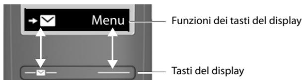
► Premere il tasto del display . . . viene richiamata la funzione visualizzata al di sopra sul display.
