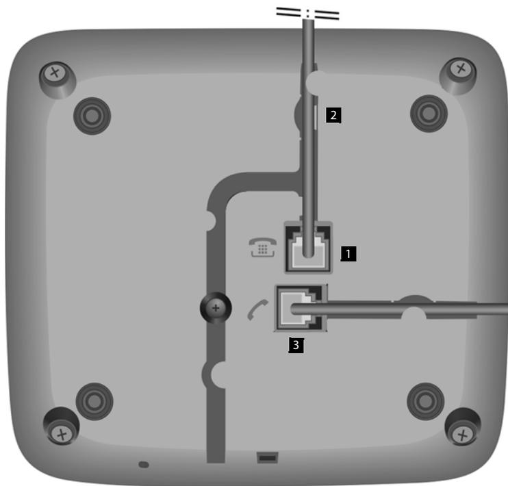
▶ Подсоедините разъем телефона (1) к телефонной розетке. Пользуйтесь телефонным кабелем из комплекта поставки.
