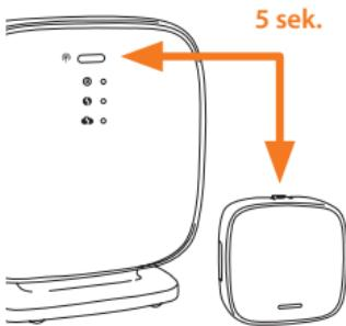
Pokrenite Gigaset aplikaciju i kliknite na „water“; pritisnite dodaj „+“; odaberite „sve ostale senzore“ i slijedite upute.
