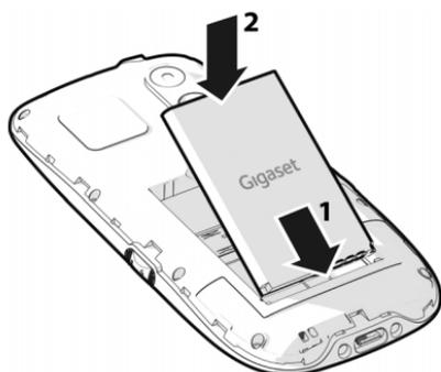
1 Legen Sie den Akku wie abgebildet ein. Achten Sie auf die korrekte Ausrichtung.
