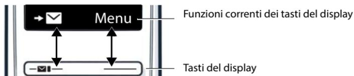
► Premere il tasto del display . . . viene richiamata la funzione visualizzata al di sopra sul display.
