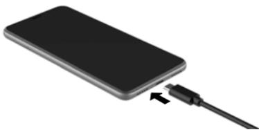
Durante el proceso de carga, el LED de mensajes se enciende en rojo (→ p. 3). El dispositivo estará cargado cuando el LED de mensajes se encienda en verde y el icono de carga
