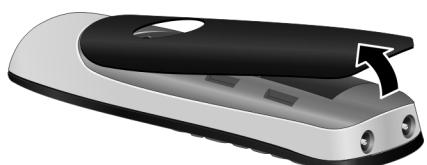
Falls Sie den Akkudeckel wieder öffnen müssen, um z. B. die Akkus zu wechseln, greifen Sie in die Mulde am Gehäuse und ziehen den Akkudeckel nach oben.
