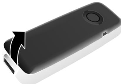
Zum Wechseln des Akkus mit dem Fingernagel in die Mulde im Gehäuse greifen und den Akku nach oben ziehen.
