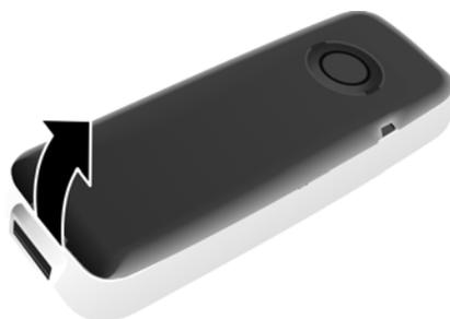
Per **cambiare la batteria** afferrare con l'unghia nell'alloggiamento del vano batterie e sollevare il pacchetto batterie verso l'alto.
