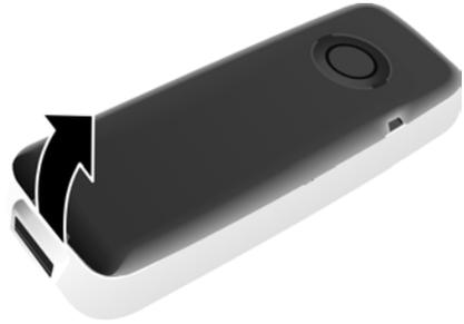
Para **cambiar la batería** introduzca la uña en la muesca de la carcasa y levante la batería.
