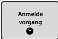
Das Mobilteil meldet sich automatisch an. Die Anmeldung kann **bis zu 5 Minuten** dauern. **Nehmen Sie das Mobilteil während dieser Zeit nicht aus der Basis.**
