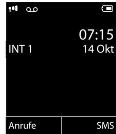
Ist der **Eco-Modus+** ( → S. 58) aktiviert, wird oben links das Symbol angezeigt. Der Anrufbeantworter ist mit einer Standardansage eingeschaltet.
