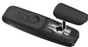
Otvorenie krytu priestoru pre akumulátory, napríklad pri výmene akumulátorov:
