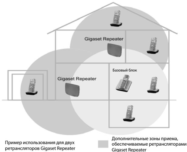
Перед началом регистрации установите ретранслятор Gigaset Repeater в непосредственной близости от базового блока и сетевой розетки. Если вы уже используете ретранслятор Gigaset Repeater, то для регистрации он должен быть установлен во включенном состоянии рядом с базовым блоком.
